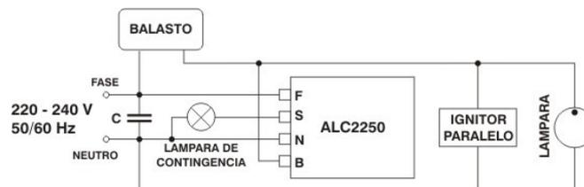
\*Para lámpara de vapor de mercurio se omite el ignitor.
